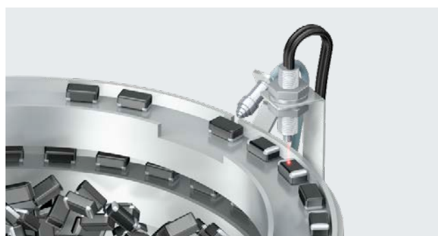
部件正反检测时的吹气输出
