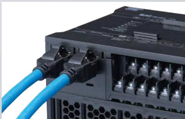
Ethernet 2端口(内置L2交换式集线器功能)
