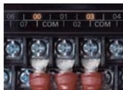
通过与端子台排列对应的输入输出显示LED配置，可迅速确定接线故障位置。
